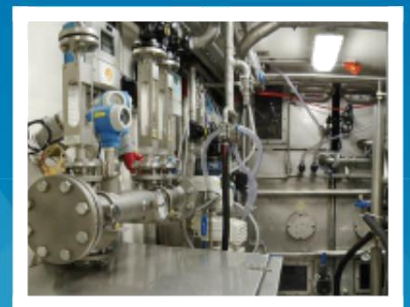
Pełnowymiarowa jednostka testowa do prowadzenia testów na terenie zakładu. Wielostopniowa jednostka pilotowa FlooBed® jest kompaktowym procesem wbudowanym w standardowy kontener i zaprojektowanym specjalnie do przeprowadzania prób na terenie zakładu. Proces jest w pełni zautomatyzowany.
